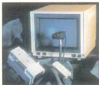
Bild 1. Matsushitas Micro Image Checker bringt Bildverarbeitung in den Schaltschrank.
